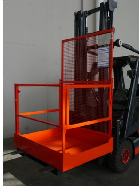
Abb. 3 Arbeitsbühne am Gabelstapler
